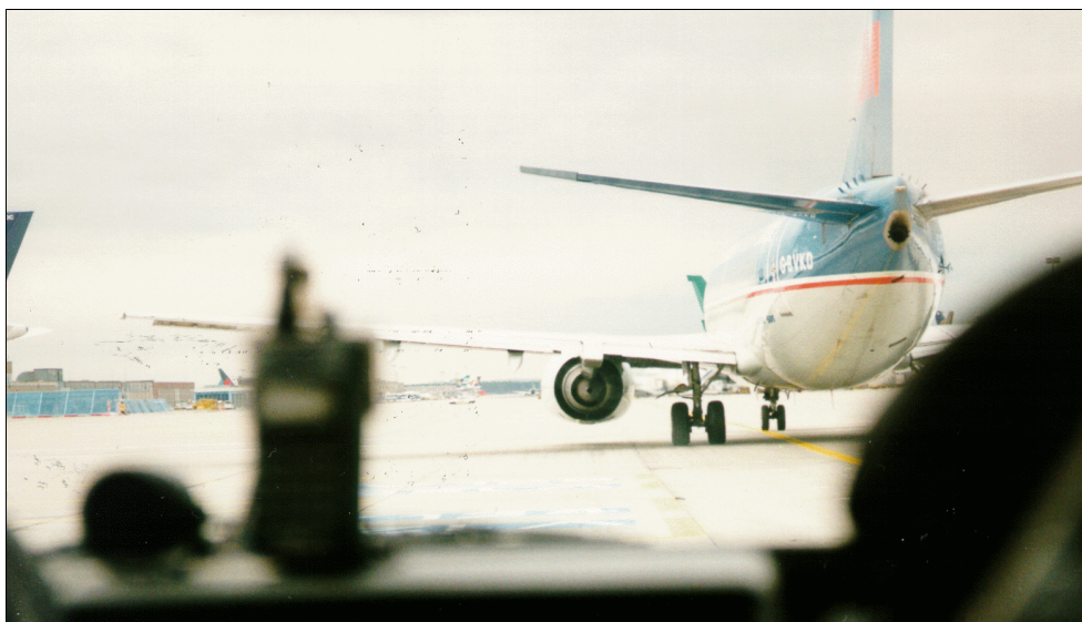
Abbildung 39: Hinterherfahrt zur Beprobung von Flugzeugtriebwerken (Sicht aus hinterherfahrendem Follow-me-Fahrzeug)
