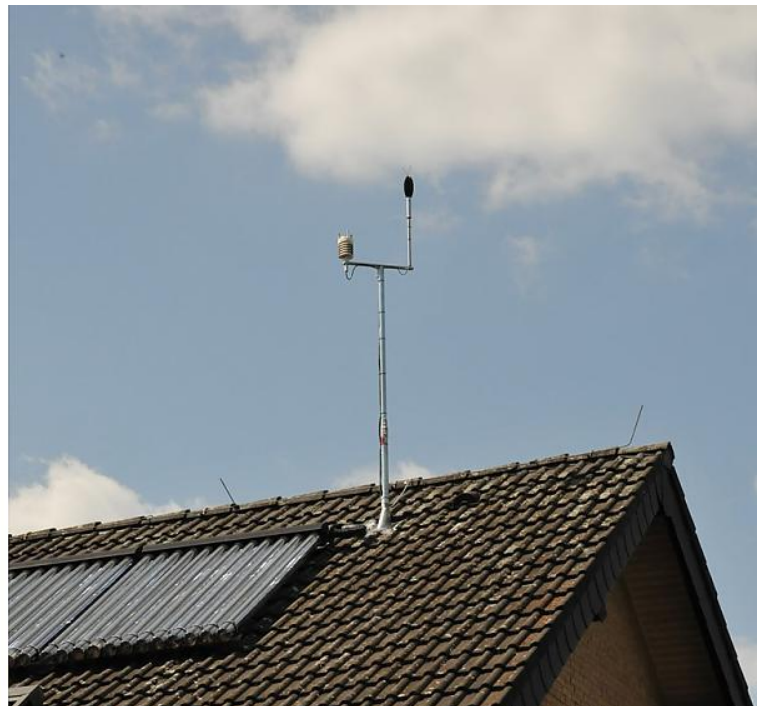
Zwei mobile und neun fest installierte Messstationen erfassen den Fluglärm (Quelle: UNH)
