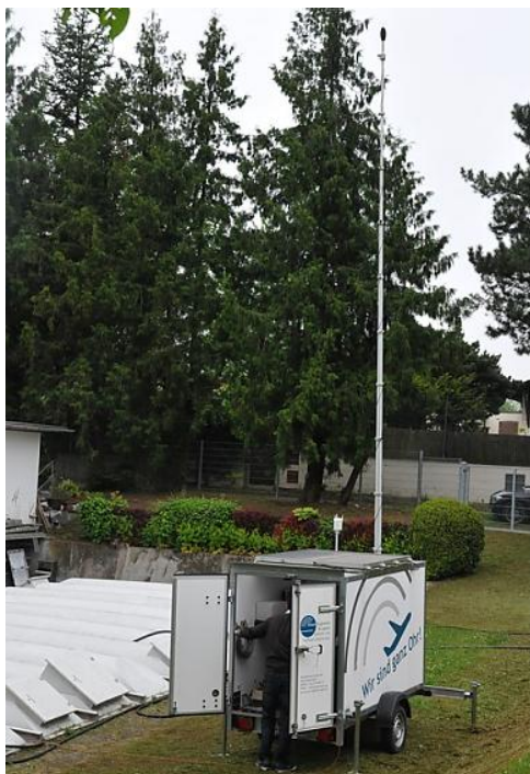
Drei mobile und neun fest installierte Messstationen erfassen den Fluglärm (Quelle: UNH)
