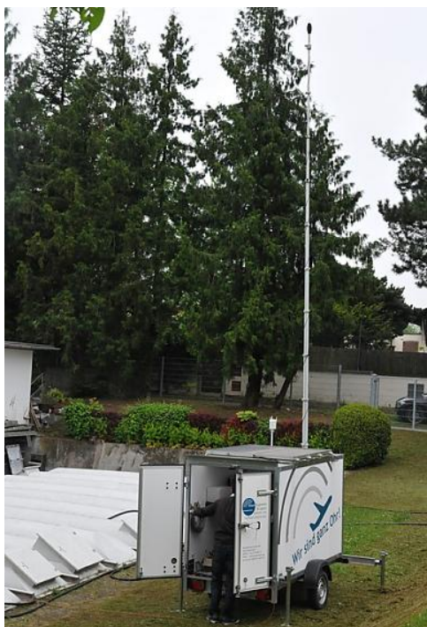
Zwei mobile und neun fest installierte Messstationen erfassen den Fluglärm (Quelle: UNH)
