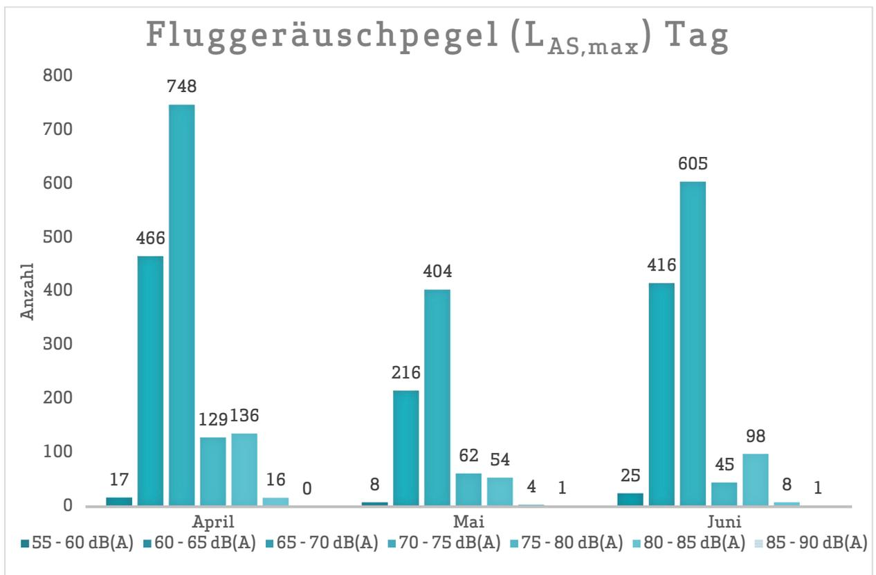
Abb. 9: Maximalpegelverteilung am Tag (Fluggeräusch)
