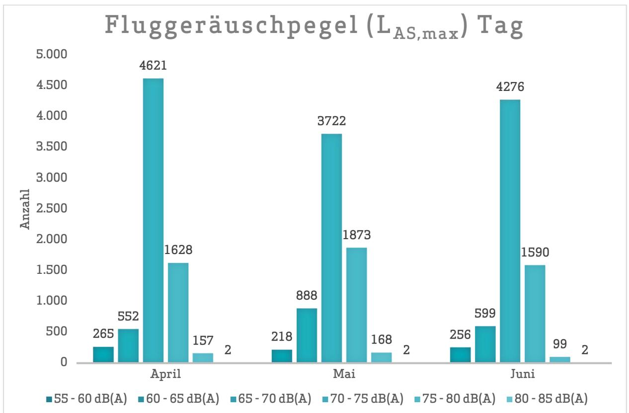
Abb. 9: Maximalpegelverteilung am Tag (Fluggeräusch)
