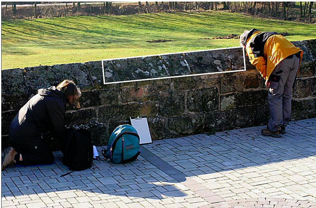
Abb. 13: Untersuchung einer Natursteinmauer auf Flechten
